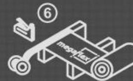
6 ТЩАТЕЛЬНО ГЕРМЕТИЗИРУЙТЕ МОНТАЖНЫМИ ЛЕНТАМИ МЕСТА КРЕПЛЕНИЯ СТЕПЛЕРОМ И ПРИМЫКАНИЯ К КОНСТРУКЦИИ
